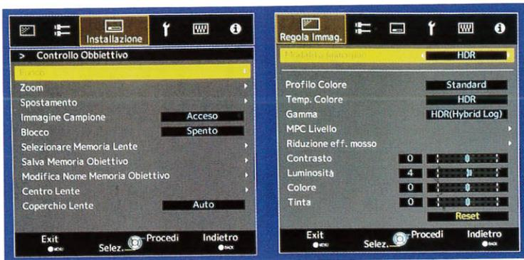
A sinistra, la sezione del menu dedicata al controllo dell'obiettivo: particolarmente utile è la funzione che permette di memorizzare i dati di posizionamento della lente in modo di passare in automatico, ad esempio, da una dimensione di immagine proiettata ad un'altra. A destra, la sezione con i vari parametri su cui è possibile intervenire nel caso di proiezione con HDR attivo.
