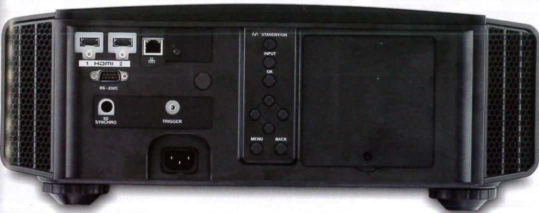
Sul retro dell'apparecchio è collocato lo sparuto parco dei connettori: in alto a sinistra, il doppio ingresso HDMI e la presa LAN, USB; sotto, la presa RS-232C per controllo remoto, il connettore per l'emettitore di sincronizzazione 3D in radiofrequenza ed un trigger. Al centro si notano i tasti basilari per il controllo direttamente dal corpo macchina.
